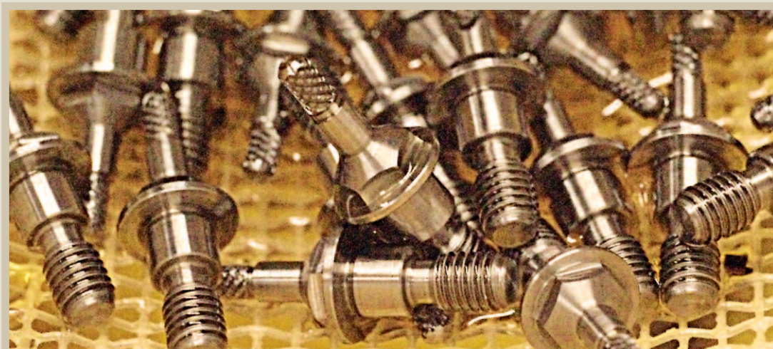
Bild 2. Komplett von der Stange: In mittleren und großen Serien fertigt Spalinger Präzisionsmechanik kleinste Drehteile unbeaufsichtigt auf Drehautomaten
