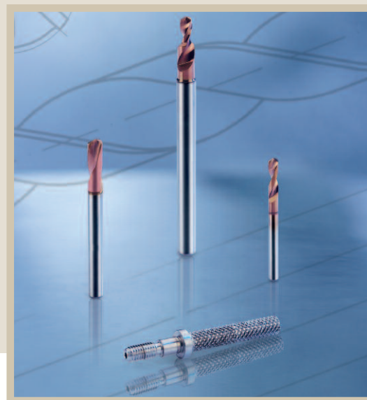
Bild 4. Pilotstufenbohrer zentrieren und fassen die kleinen Bohrungen, damit VHM-Mikrobohrer prozesssicher bis 20 \times D durchbohren können
